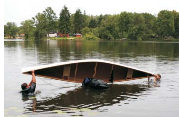
Das Boot wird mit Schwung gedreht, so daß kein Wasser einlaufen kann
